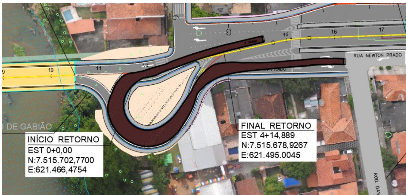
Figura 14 - Projeto Geométrico Retorno – Estudo de Giro Semi-Reboque.
